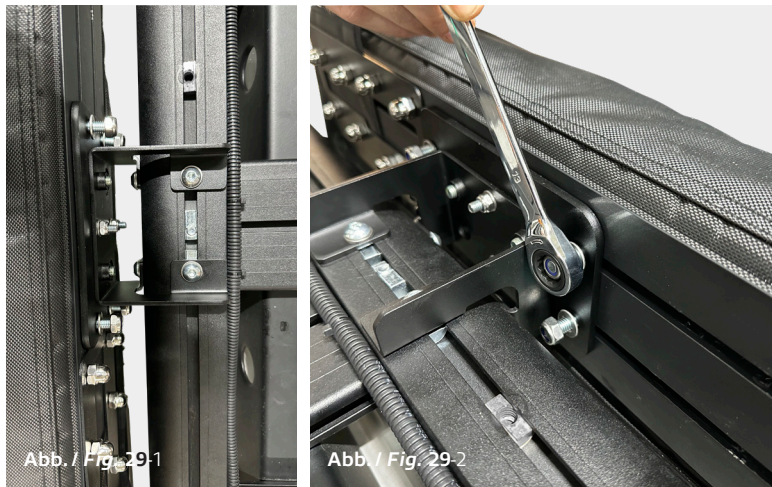
Festziehen der Muttern / Tightening the nuts
