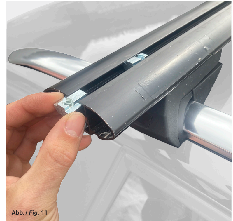
Einsetzen Nutensteine / Insert slot nuts
