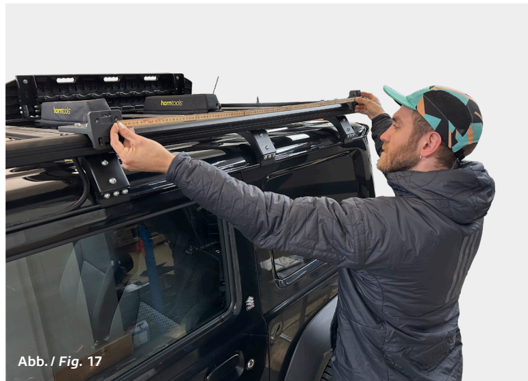
Abstand Befestigungslöcher / Distance mounting holes
